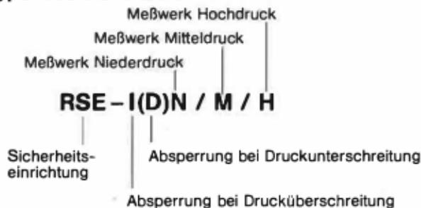
**Meßwerk N:** Die Druckdifferenz zwischen Regelgerät und unterem Schaltpunkt muß mind. 10 mbar betragen. Zur Schaltung bei Druckanstieg sind mind. 20 mbar Druckdifferenz erforderlich.
